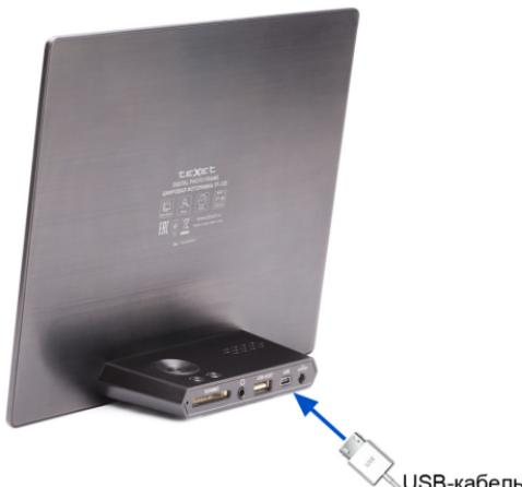
Подключите USB-кабель сначала в USB-порт компьютера, а затем в USB-разъем фотопресса. Включите питание фотопресса. На дисплее появится надпись “Соединение установлено...”, фотопресс подключена к ПК.
